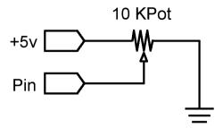
El uso de un potenciómetro y uno de los pines de entrada analógicadigital de Arduino (ADC) permite leer valores analógicos que se convertirán en valores dentro del rango de 0-1024. El siguiente ejemplo utiliza un potenciómetro para controlar un el tiempo de parpadeo de un LED.
