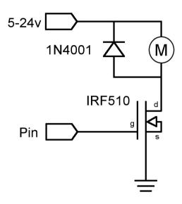
A veces es necesario controlar cargas de más de los 40 mA que es capaz de suministrar la tarjeta Arduino. En este caso se hace uso de un transistor MOSFET que puede alimentar cargas de mayor consumo de corriente. El siguiente ejemplo muestra como el transistor MOSFET conmuta 5 veces cada segundo.
