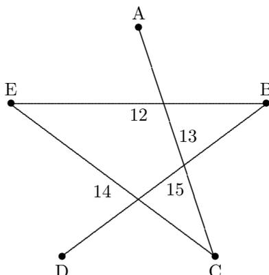
Figura 6.10: Árbol generador minimal obtenido por los algoritmos de Kruskal y Prim en el ejemplo 6.12.
