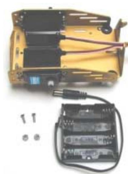
Figura 1.26: Porta pilas y tornillos para su montaje.
