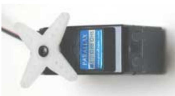
Figura 1.17: Vistas del servo: (a) delantera
