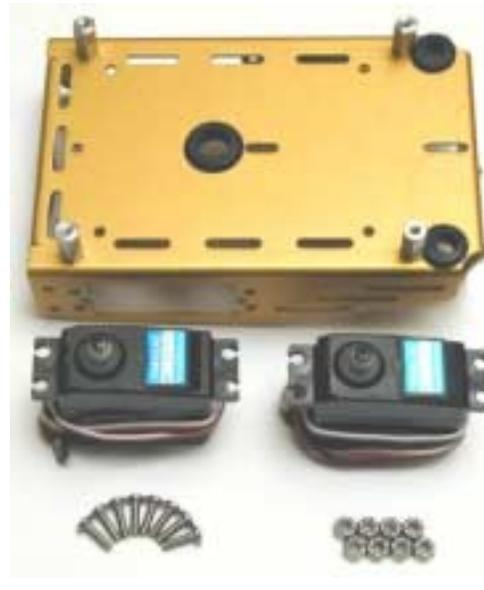
Figura 1.24: Servos y hardware para su montaje.
