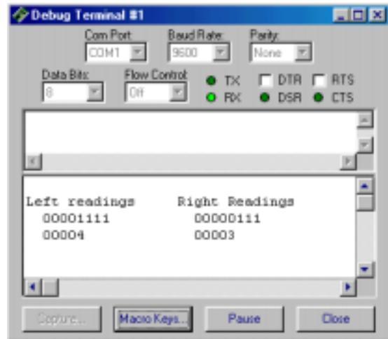
Figura 6.2: Datos de barrido de frecuencia en formato binario y ncd.
