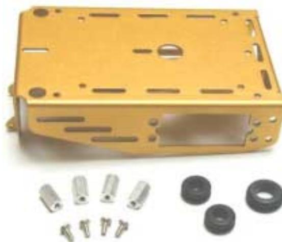
Figura 1.22: Chasis y hardware de la parte superior.
