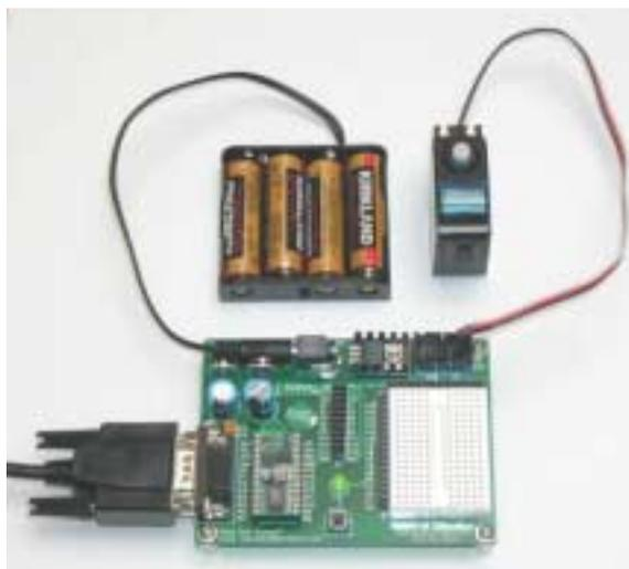
Figura 1.21: Servo rearmado listo para ser probado.
