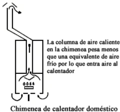
Figura II. 1. Chimenea de calentador doméstico.
