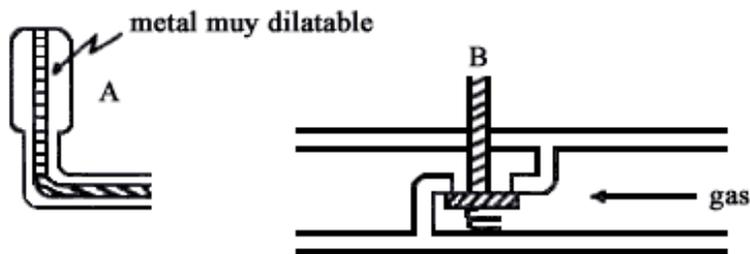
Al calentarse el metal A se expande y abre la válvula B
