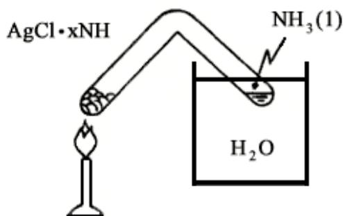
Cuando se apaga el mechero el  $\text{NH}_3(1)$  enfriando el  $\text{H}_2\text{O}$
