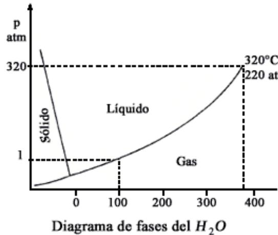
Figura II. 4. Diagrama de fases del  $H_2O$ .
