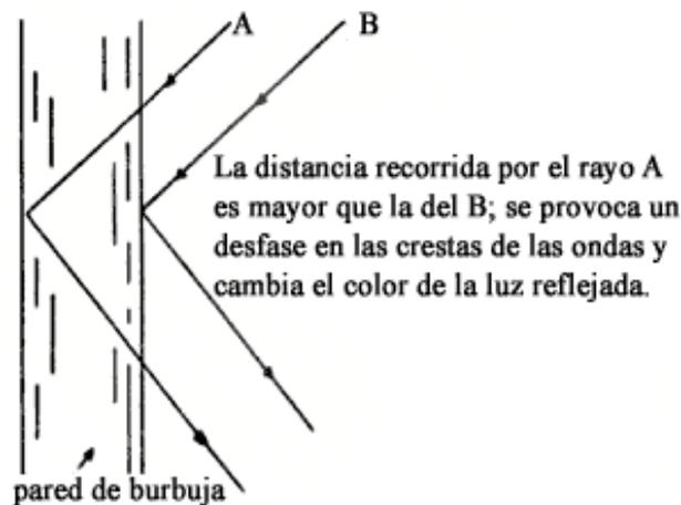
**Figura V. 4. Fenómeno de interferencia.**
