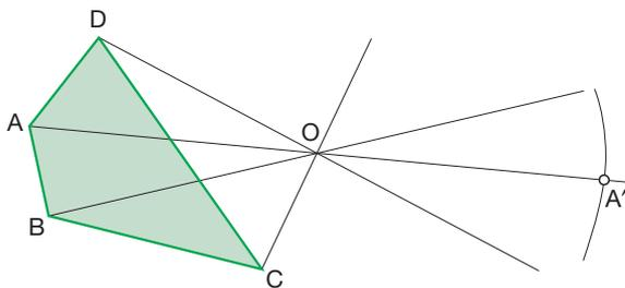
— Repetimos el proceso con los otros vértices,  $B$ ,  $C$  y  $D$ , y determinamos sus homólogos,  $B'$ ,  $C'$  y  $D'$ .
