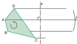
— Repetimos el proceso con los otros vértices,  $B$ ,  $C$  y  $D$ , y determinamos sus homólogos,  $B'$ ,  $C'$  y  $D'$ .
