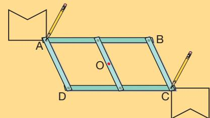
El punto  $O$  queda fijo en el papel, el extremo libre  $A$  lleva una punta con la que recorreremos la figura original que queremos reproducir, y en el vértice  $C$  se coloca un lápiz. Al recorrer la figura original con la punta del extremo  $A$ , el lápiz dibuja la figura simétrica respecto del punto  $O$ .
